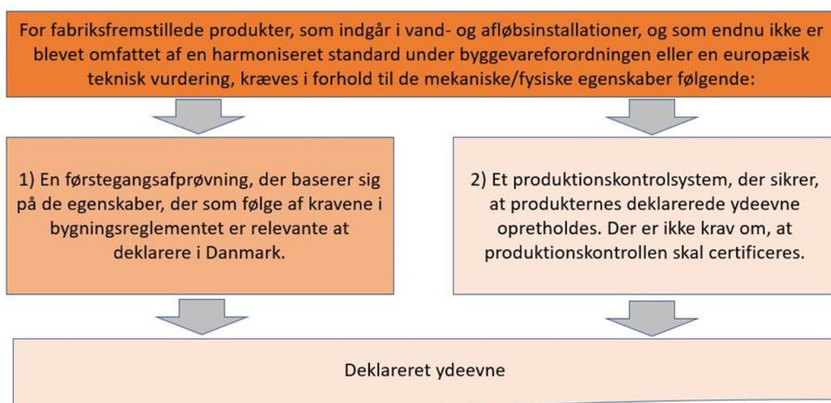
Figur 3.20. Oversigt over de krav, der stilles for at kunne markedsføre og sælge et produkt til vandinstallationer i Danmark
